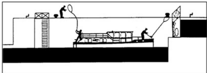
Jeweils eine Person an Bord nimmt die vordere und die hintere Leine und holt diese beim Ansteigen des Bootes laufend dichter. Halten Sie das Boot eng an der Kammerwand.
