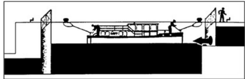
Nach Erlaubnis zur Ausfahrt oder Hinweis auf Anzeigetafel Leinen einholen; darauf achten, dass keine Leine ins Wasser fällt und in die Schiffsschraube gerät. Langsam und vorsichtig ausfahren.
